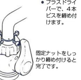
取り付け後、切換えレバーでの動作(原水・シャワー・浄水)を確認してください。
