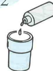
PH測定液を2滴ほど滴下し、指で試験カップの口を押さえてよく振ってください。
