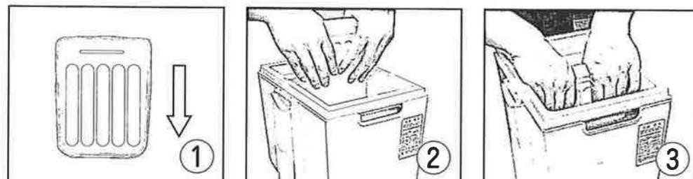
※ 非常に硬い場合は、取り付ける前に電解水槽の溝を水で濡らしてから
