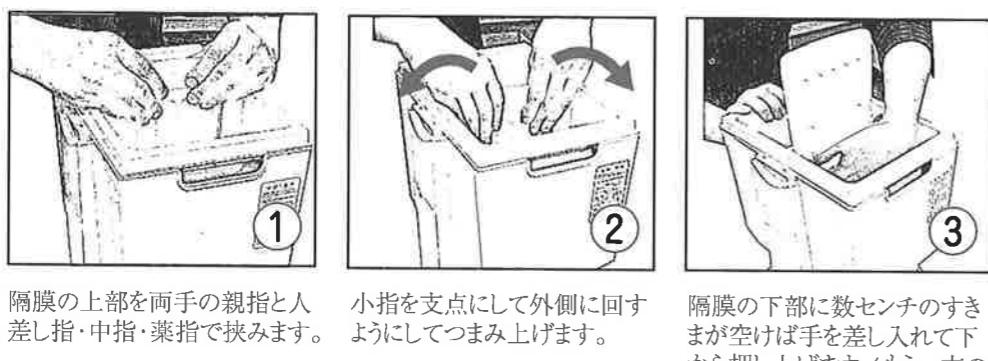
※ 取り外した隔膜は、軽く水洗いして拭き取ってから直射日光を避けて保管して下さい。
