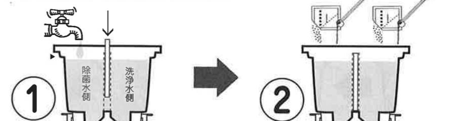
取り出した電解水槽に隔膜を装着し、両方の槽に水位線まで水を入れる。
