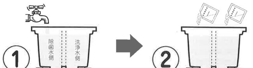
隔膜は装着されていない電解水槽を取り出し、水位線まで水を入れる。
